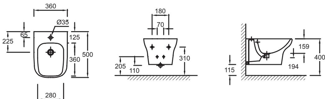
Descriptif CCTP : Bidet suspendu. EME0002. Collection : VOX. DIMENSIONS : 50,50 x 35 cm. POIDS : 17,9 kg. MATÉRIAU : Céramique. TYPE D'INSTALLATION : Suspendu. PRODUIT INCLUS : (robinetterie non incluse). ABATTANT : Inclus. GARANTIE DE LA CÉRAMIQUE : 10 ans. FIXATION DE LA CUVETTE : Cachées. Percé 1 trou de robinetterie.
