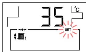
Température de consigne d'aller de l'installation de plancher chauffant choisie en appuyant sur le bouton de sélection tactile correspondant **(12)**. (uniquement dans l'option SRFC2/EV)
