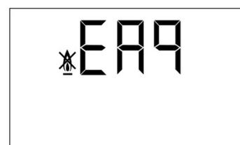
Ce blocage intervient en cas d'anomalie quelconque sur le brûleur **(10)** ou sur l'installation de combustible. Pour déverrouiller, appuyer sur le bouton lumineux qui s'allume sur le brûleur.
