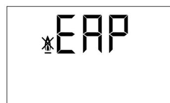
Cela se produit quand la pression de la chaudière descend en-dessous de 0,5 bar, ce qui évite que la chaudière ne fonctionne quand l'installation se vide d'eau, soit en raison d'une fuite ou pour des opérations de maintenance. Pour débloquer, l'installation devra être à nouveau remplie jusqu'à ce qu'une pression entre 1 et 1,5 bar s'affiche sur le paramètre *pression de chaudière* de l'afficheur **(11)**.
